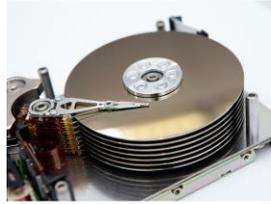
Mechanische Festplatten bestehen aus mehreren sich drehenden Scheiben, die magnetisiert werden.
